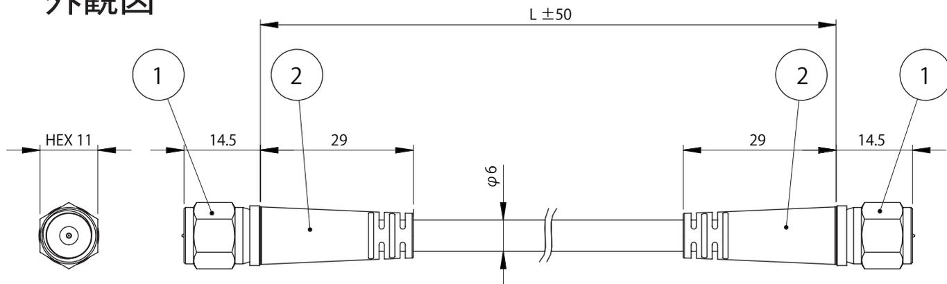
同軸ケーブル印刷内容：4K8K同軸アンテナケーブル
